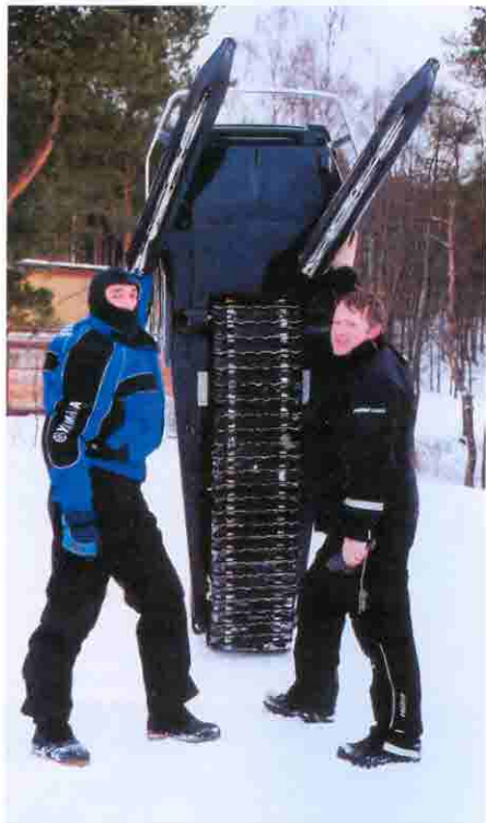
Благодаря длинной гусенице шириной 380 мм снегоход уверенно идет по рыхлому снегу
