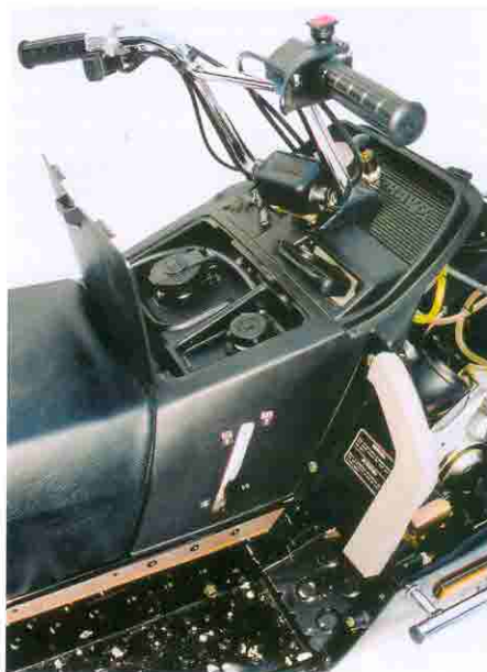
Горловины дополнительного бензобака и масляного бачка — под крышкой на панели. Ниже — трубки контроля уровня бензина и масла.
