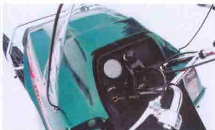
Передняя панель довольно скромна: здесь только замок зажигания, рукоятка "подсоса", праймер и спидометр
