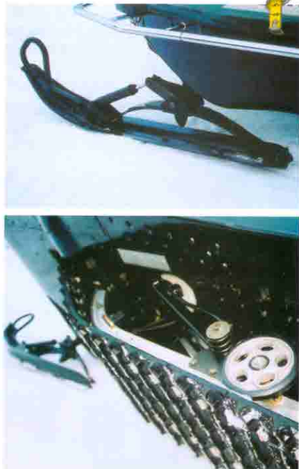
Рессорная подвеска лыж и пружинная задняя подвеска "Slide Rail" снабжены гидравлическими амортизаторами
